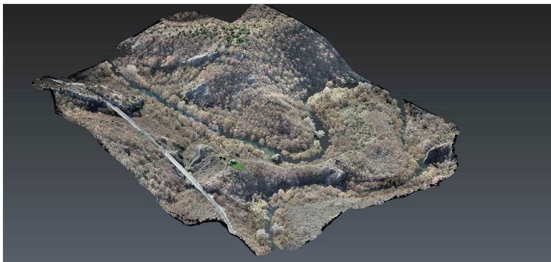
Примерок од Лидар дрон снимањето (снимање на 30 хектари со тврдината која се гледа на ридот до патот)
